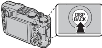
Der Lautsprecher der Kamera und das AF-Hilfslicht/die Selbstauslöserleuchte werden ausgeschaltet und die Lautstärke kann nicht eingestellt werden. Drücken Sie die **DISP/BACK**-Taste, bis das Symbol
